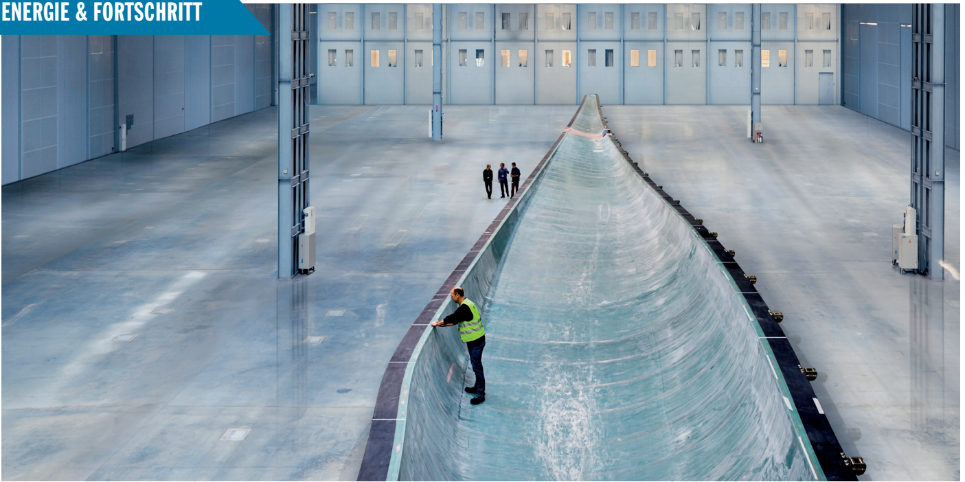
In den Hull Produktionsstätten werden zukünftig 75 Meter lange Rotorblätter gefertigt.
